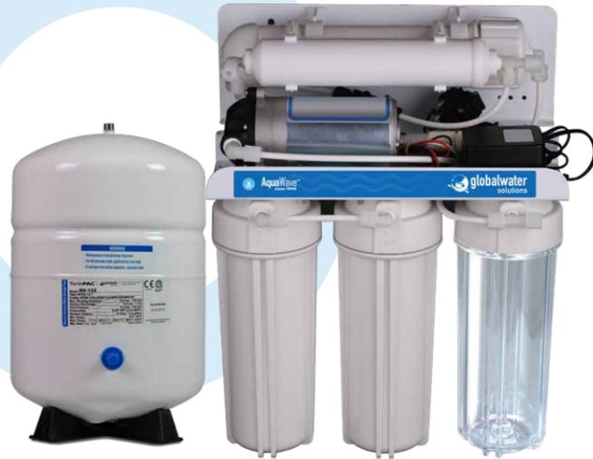
Este sistema compacto de ósmosis inversa es ideal para la purificación de agua potable residencial. El sistema de 5 etapas está diseñado con un prefiltro de sedimentos de 5 micras, un filtro de carbono GAC de segunda etapa, seguido de nuestro filtro patentado 2-in-1 BLOCKFREE, diseñado para una protección óptima de la membrana de ósmosis inversa.
