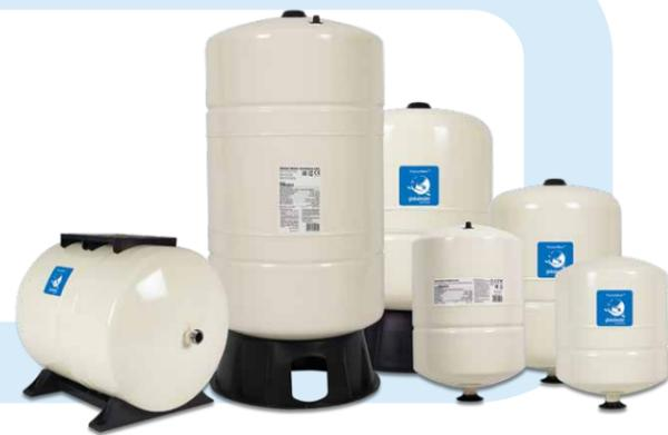
La série PressureWave™ est constituée d'un revêtement en polypropylène vierge associé à une membrane en butyle de haute qualité conforme à la FDA, qui est maintenue contre la paroi du réservoir à l'aide d'un anneau de serrage en acier. La valve d'air en laiton, scellée par un bouchon fileté à joint torique, empêche les fuites d'air. L'eau pénètre dans le réservoir par un raccord en acier inoxydable breveté.
