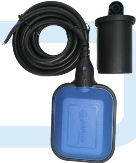
L'interrupteur à flotteur MiniWave™ est utilisé pour activer et désactiver les pompes électriques en fonction des niveaux d'eau minimum et maximum dans un réservoir aérien ou un puisard. Il protège efficacement la pompe électrique lorsqu'il n'y a pas d'eau dans le réservoir aérien ou le puisard.
