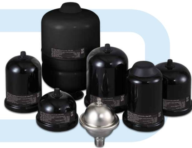
Les amortisseurs de choc HydroGuard™ sont spécialement conçus avec la dernière technologie de membrane visant à réduire et éliminer les chocs hydrauliques. Le diaphragme interne divise le parafoudre en chambres d'air et d'eau séparées. La chambre d'air scellée agit comme un coussin qui se comprime lorsque la pression de l'eau augmente soudainement, en raison d'un choc hydraulique.
